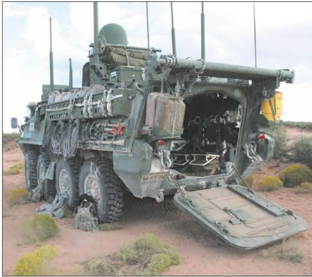
Командно-штабная машина системы связи «Вин-Т» тип 16 на базе БМ «Страйкер»
