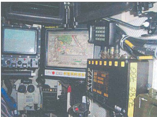
Демонстрационный макет рабочего места командира танка «Леопард-2А8» (на рисунке дисплеи отображения тактической обстановки системы управления огнем)
