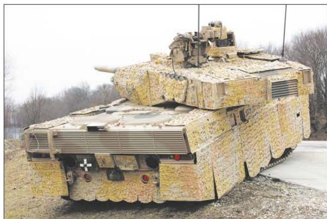
Новым в защите ОБТ «Леопард-2А8» станет наличие дополнительного бронирования на крыше корпуса и башни
