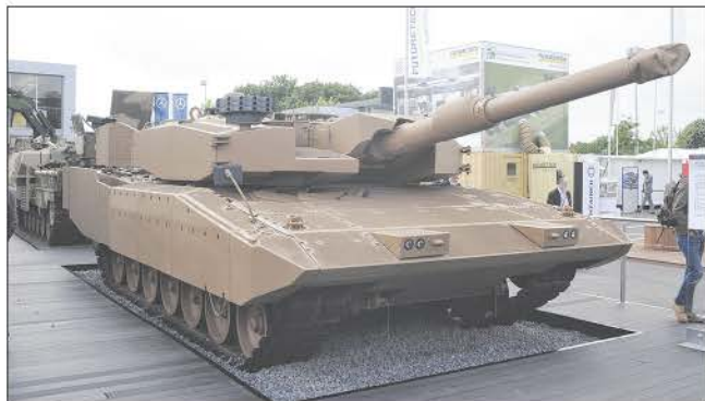
Танк «Леопард-2А4 Эволюшн» представляет собой глубокую модернизацию версии 2А4 и имеет улучшенную защиту от мин и самодельных взрывных устройств
